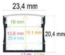
Perfil LED de superficie de 23,4 mm x 20,4 mm
