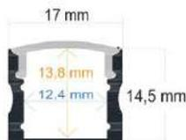
Perfil LED de superficie de 17 mm x 14,5 mm
