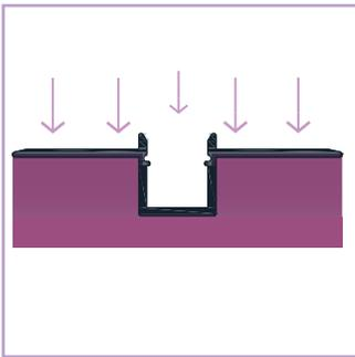
① Disponer el perfil en una superficie con material adherente, tal como cemento
