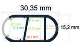
Perfil LED para interior de armarios de 15,2x30,35 mm.
