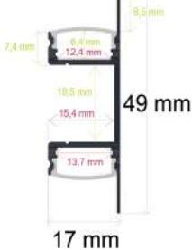
Perfil LED de pared con iluminación bidireccional de 49 x17 mm.
