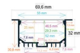
Perfil LED para empotrar en techos o paredes de 69,6 x 32 mm
