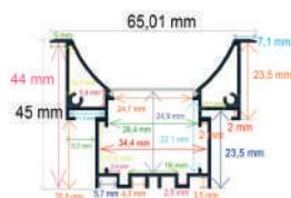
Perfil LED cóncavo para empotrar en techos o paredes de 65,01 x 45 mm
