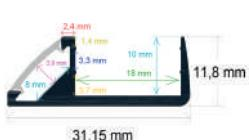
Perfil LED para interior de armarios de 31,15x11,8 mm.
