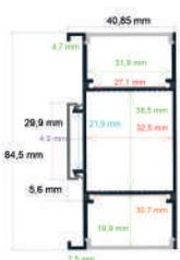
Perfil LED de pared con iluminación bidireccional de 40,85x84,5 mm.
