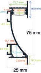
Perfil LED para paredes y rodapié de 75 x 25 mm.
