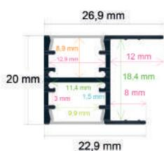
Perfil LED para muebles, con iluminación bidireccional de 26,9x20 mm.
