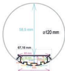
Perfil LED cilíndrico extra grande de Ø 120 mm.
