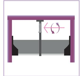
④ Atornillar el accesorio central de sujeción al techo del armario
