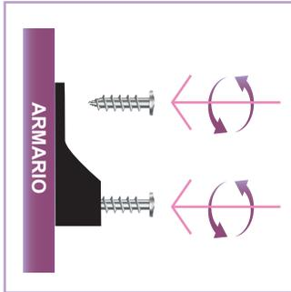
① Atornillar las dos tapas en ambos extremos del armario
