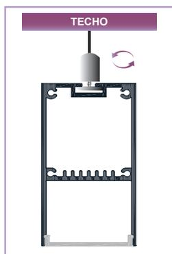
② Poner el perfil y enroscar el anclaje para sujetarlo
