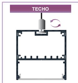
② Poner el perfil y enroscar el anclaje para sujetarlo
