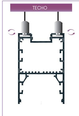
② Poner el perfil y enroscar los anclajes para sujetarlo
