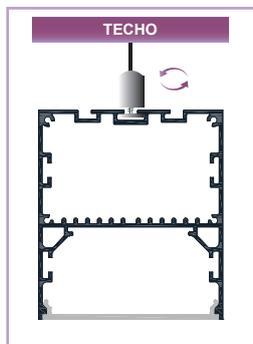
② Poner el perfil y enroscar el anclaje para sujetarlo
