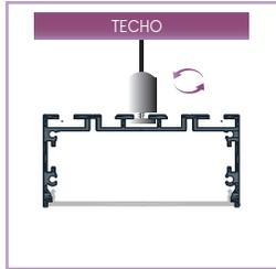
② Poner el perfil y enroscar el anclaje para sujetarlo
