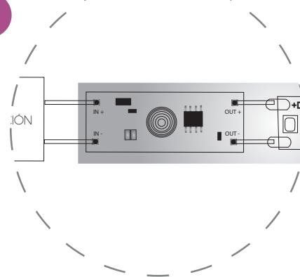
Colocar dentro del perfil LED con el difusor y comprobar su correcto funcionamiento
