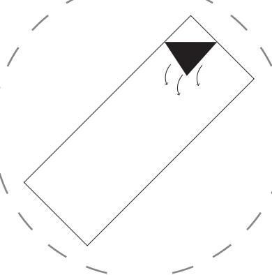
Despegar el adhesivo de la parte trasera del módulo y pégalos a la superficie del perfil para adherirlo
