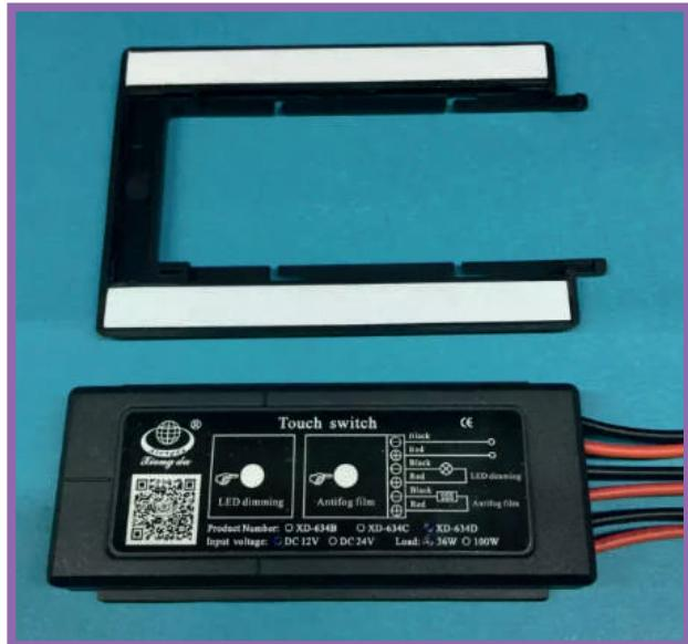
Método de cableado: un conjunto de cables rojos y negros están conectados a "+, -" CC: entrada de 12 V, el otro conjunto de cables rojos y negros están conectados a la tira de luz de 12 V y los dos cables amarillos se usan para controlar una línea neutra de 220v o el cable vivo está conectado a la película antivaho y el cabezal táctil negro está instalado en la parte posterior del espejo.
